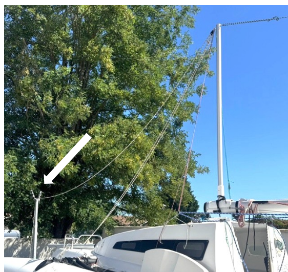
Figure 2 l'estrope en tension. Malgré l'effet d'optique, l'œil de l'estrope (C) est bien dans l'axe de rotation du mât.
