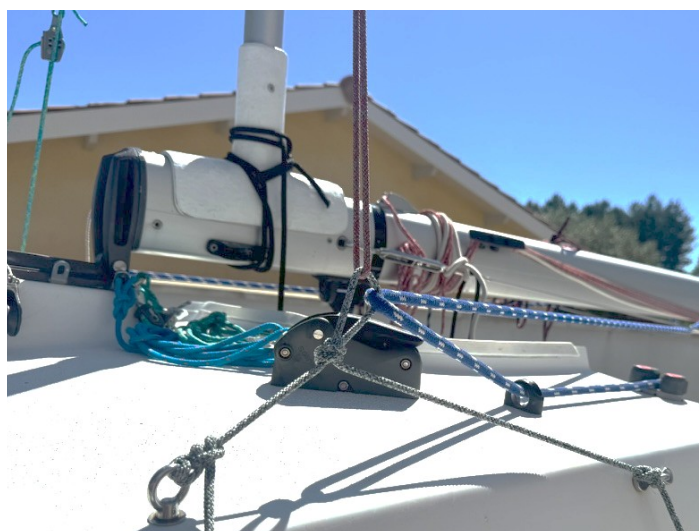
Figure 2 l'estrope en tension. Malgré l'effet d'optique, l'œil de l'estrope (C) est bien dans l'axe de rotation du mât.
